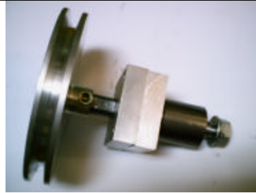
Como va montado el conjunto del eje y la polea
