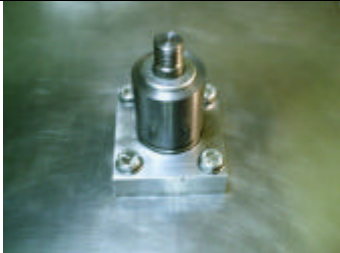
Los soportes y rodamientos ya atornillados en la chapa
