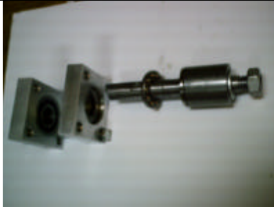
Rodamientos y eje. La chapa va entre los dos soportes
